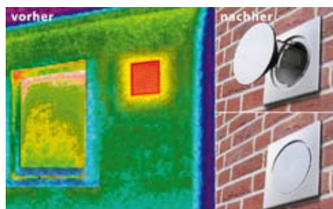
Kostbare Energie verschwendet eine Dunsthaube mit konventionellen Mauerkasten. Der wärmegeämmte Mauerkasten der Firma Weibel löst dieses Problem.
